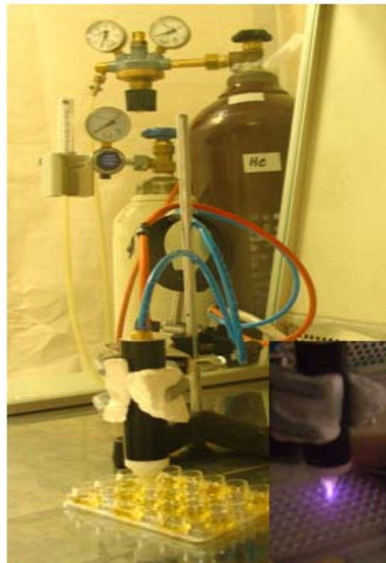
شکل ۲. چینش دستگاه جت پلاسما اتمسفری سرد استفاده شده در این مطالعه
