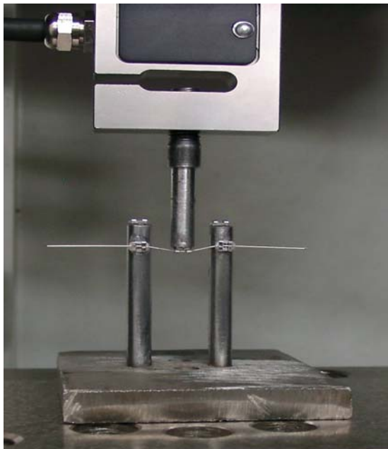
شکل ۱: فیکسچر و نمونه سیم در حالت خمش
