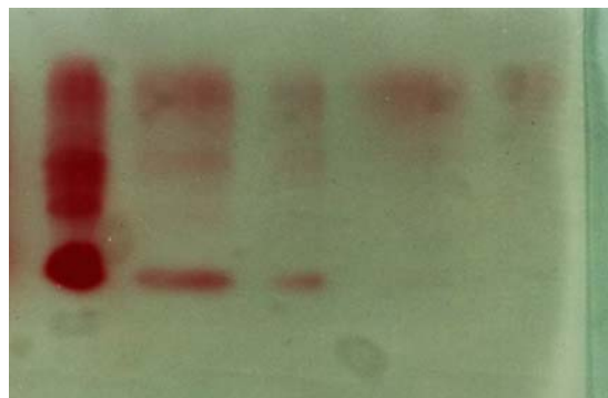
شکل ۴. الکتروفورز استات سلولز سرم خرگوش (۱)، محصولات کروماتوگرافی سفادکس G-25: (۲و۳) و محصولات کروماتوگرافی T-gel (۵و۶)
