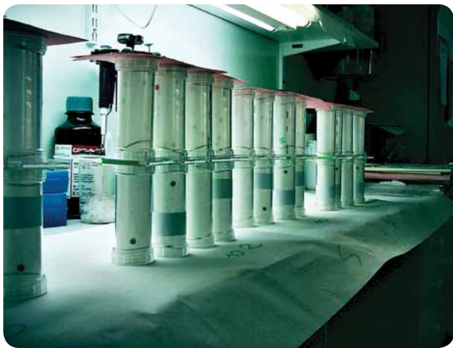
Tubes de maintien utilisés pour l'évaluation de la sensibilité des vecteurs aux insecticides
