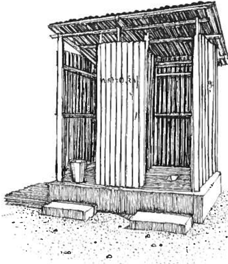
الشكل ٩-٣ مرحاض حفرة ينظف بسكب الماء
