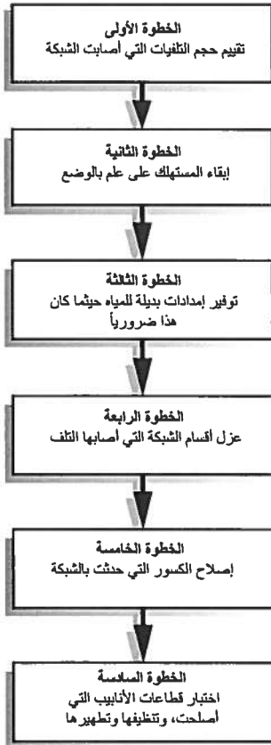
الشكل ١-٤ خطوات إعادة تأهيل الشبكات الصغيرة لتوزيع أنابيب المياه
