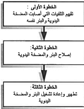
الشكل ١-٢ خطوات تنظيف الآبار العميقة ذات الفوهة الصغيرة وتطهيرها
